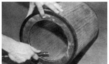
По окончании очистки проверьте фильтроэлемент на отсутствие повреждений. Осмотрите его снаружи. Установите проверочную лампу внутри фильтроэлемента и просветите его. Щели, разрывы, непроклеи, деформация внешней или внутренней обечайки или другие повреждения не допускаются. При обнаружении указанных дефектов замените фильтроэлемент элемент.
