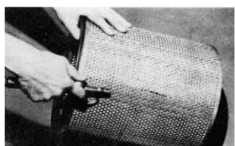
**Примечание:** допускается выполнять очистку фильтроэлемента не более 5 раз, после чего фильтроэлемент воздушного фильтра должен быть заменен на новый.
