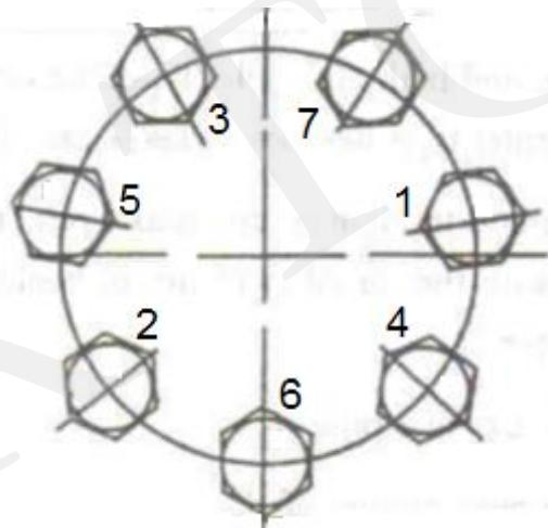
Рис.4. Последовательность затяжки болтов маховика
