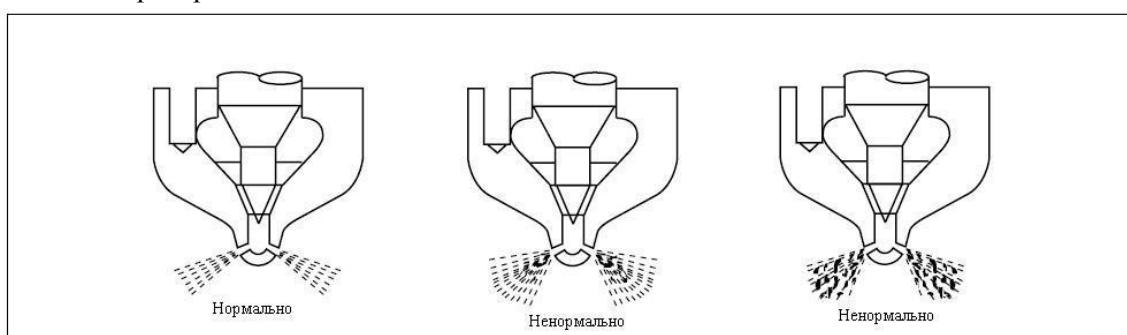
Давление открытия форсунки должно быть 20(+1) МПа, при недостаточном давлении открытия форсунки давление необходимо отрегулировать с помощью регулировочных шайб; увеличение толщины пакета регулировочных шайб на 0,1 мм увеличивает давление открытия форсунки примерно на 1 МПа.
