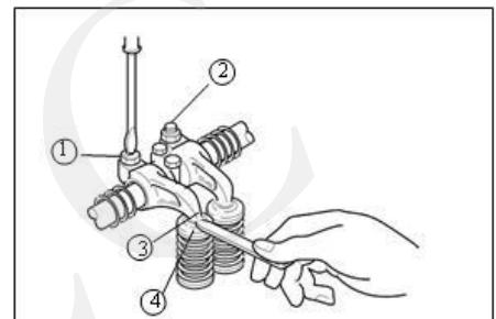
**Примечание:** Зазор выставлен правильно, если щуп может двигаться между клапаном и коромыслом с легким сопротивлением.
