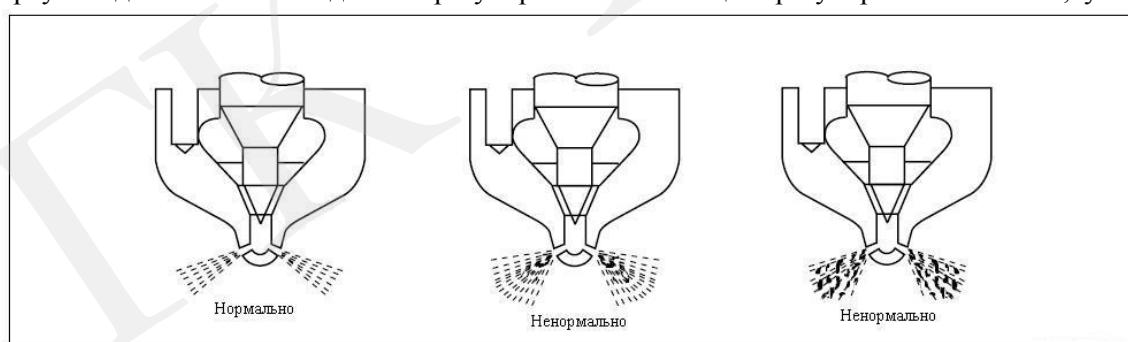
толщины пакета регулировочных шайб на 0,1 мм увеличивает давление открытия форсунки примерно на 1 МПа.
