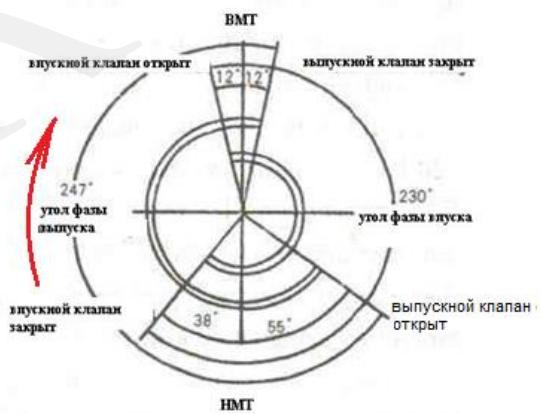
Рис.2. Углы открытия-закрытия клапанов
