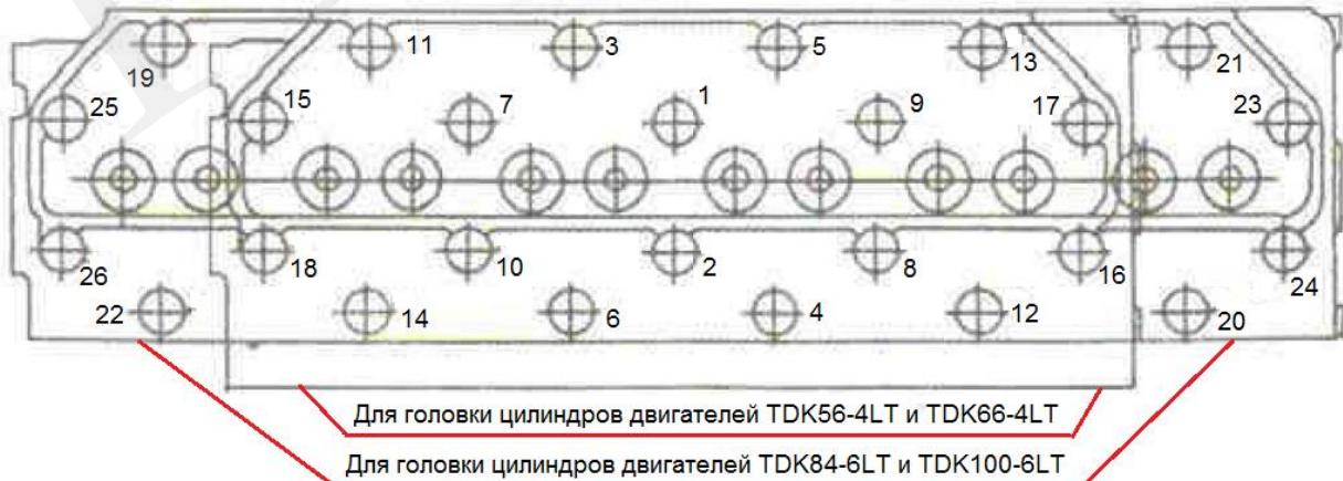
Рис. 1. Последовательность затяжки болтов головки цилиндров
