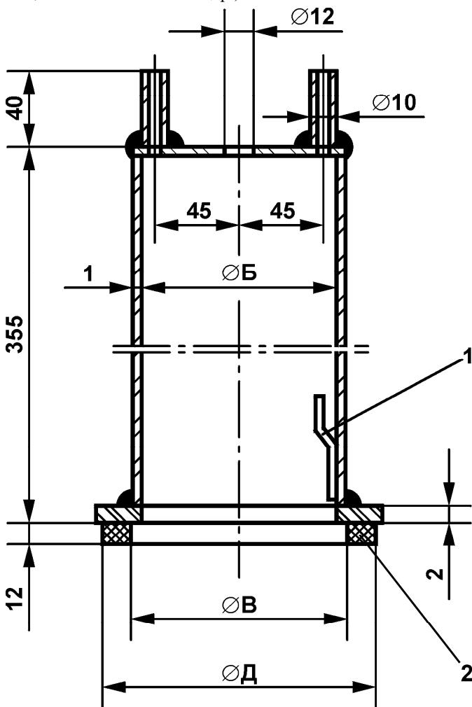
Рисунок 35. Заглушка для проверки герметичности
