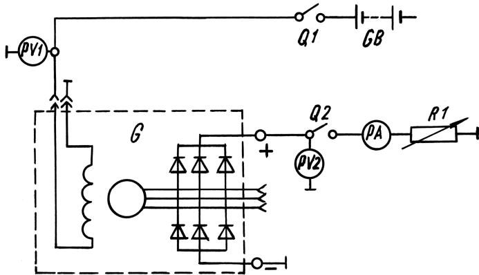
G - генератор; Q1 и Q2 - выключатели; PY1 и PY2 - вольтметры; R1 - реостат; PA - амперметр; GB - аккумуляторная батарея.
