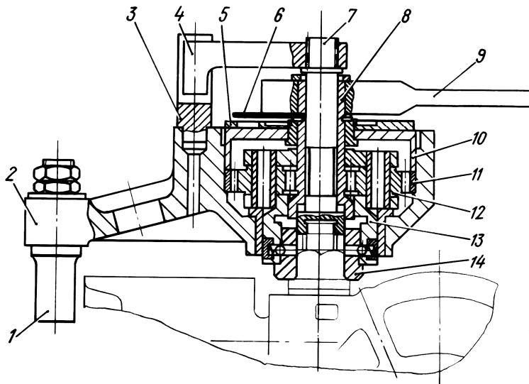
1 - упор; 2 - корпус; 3 - вилка; 4 - рычаг; 5 - диск; 6 - стрелка;
