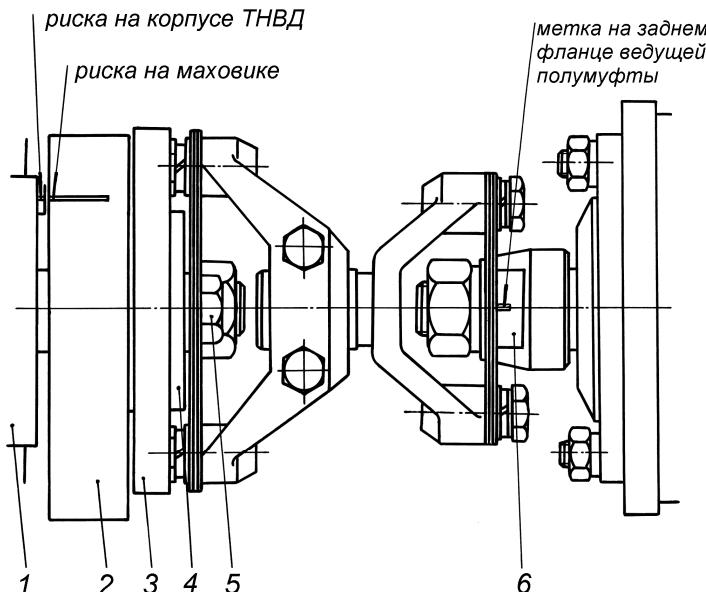
1 - корпус топливного насоса высокого давления; 2 - маховик топливного насоса высокого давления; 3 - ведомая полумуфта; 4 - фланец ведомой полумуфты; 5 - болт крепления ведомой полумуфты; 6 - задний фланец ведущей полумуфты.
