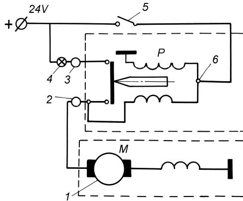
1 - электродвигатель стартера; 2 - клемма подключения перемычки стартера к реле; 3 - выводной болт подключения аккумуляторной батареи к реле; 4 - контрольная лампочка; 5 - выключатель; 6 - клемма подключения провода от выключателя к обмоткам реле.
