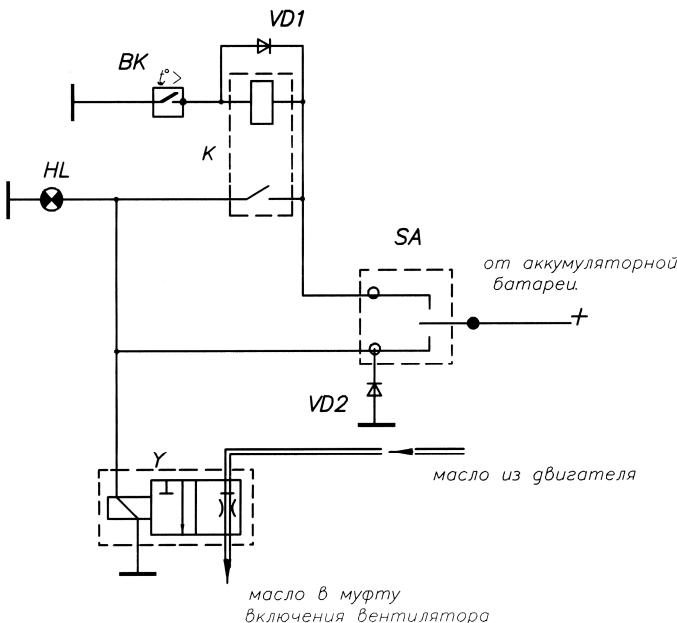
Рис. 38. Схема включения муфты вентилятора
