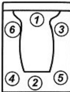
Рисунок 9 – Порядок затяжки болтов крепления головок цилиндров
