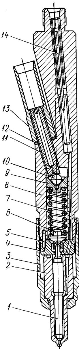
1 – игла распылителя; 2 – корпус распылителя; 3 – гайка распылителя; 4 – проставка; 5 – штифт; 6 – штанга; 7 – пружина; 8 – корпус форсунки; 9 – тарелка пружины; 10 – шарик; 11 – регулировочный винт; 12 – прокладка; 13 – гайка; 14 – стержень фильтра.
