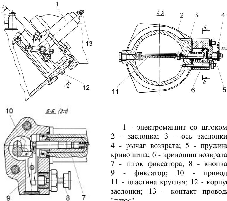
Рисунок 23 – Заслонка аварийного останова с приводом.
