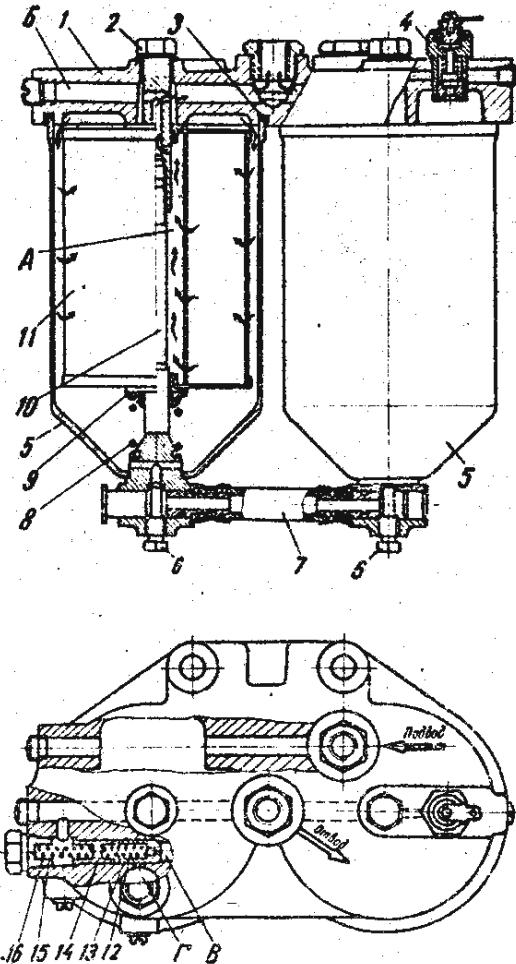
1 – корпус фильтра; 2 – болт; 3 – прокладка колпака фильтра;
