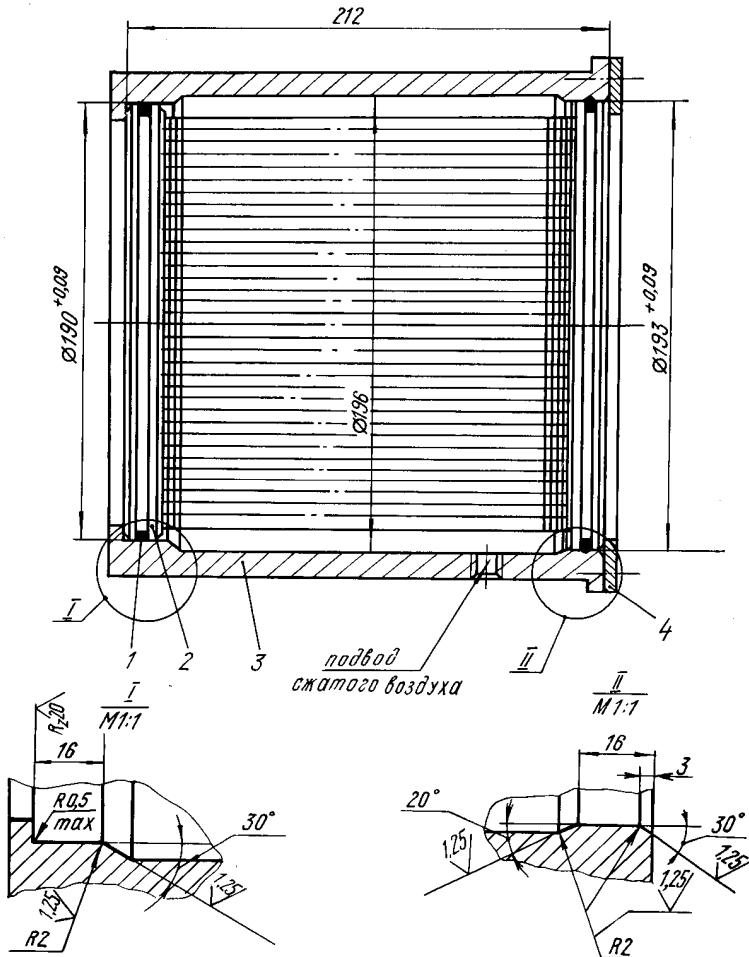
1 - кольцо уплотнительное; 2 - охлаждающий элемент; 3 - корпус; 4 - стопорное кольцо
