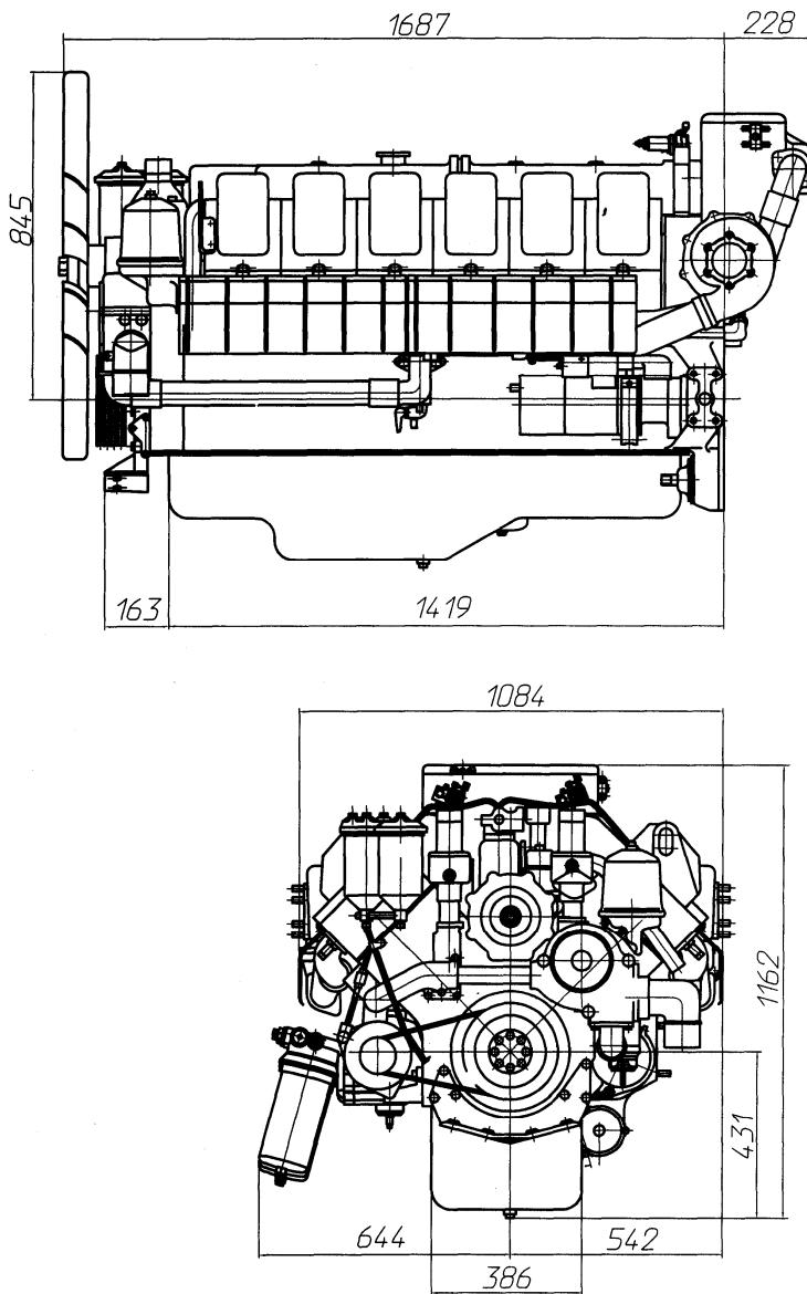
Рисунок 2 – Габаритные размеры двигателя
