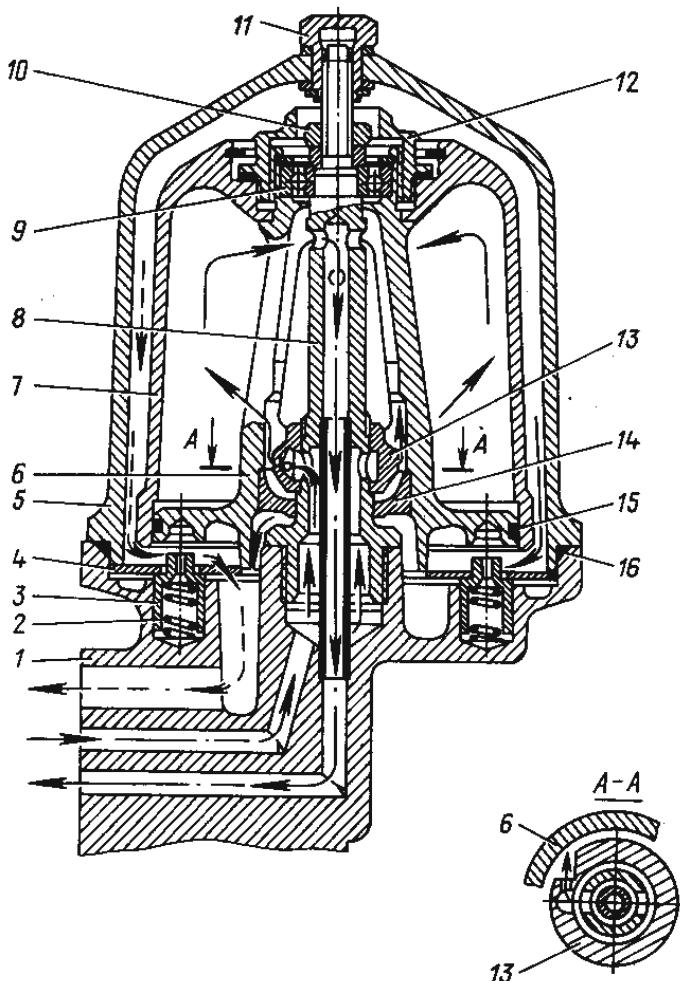
1 — корпус фильтра; 2 — пружина; 3 — стопорный палец;
