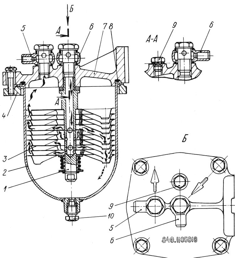
1 – ось; 2 – стакан фильтра; 3 – фильтрующие диски; 4 – фланец; 5 – наконечник топливной трубы отвода топлива; 6 – наконечник топливной трубы подвода топлива; 7 – крышка фильтра; 8 – прокладка; 9 – пробка для выпуска воздуха; 10 – сливная пробка.
