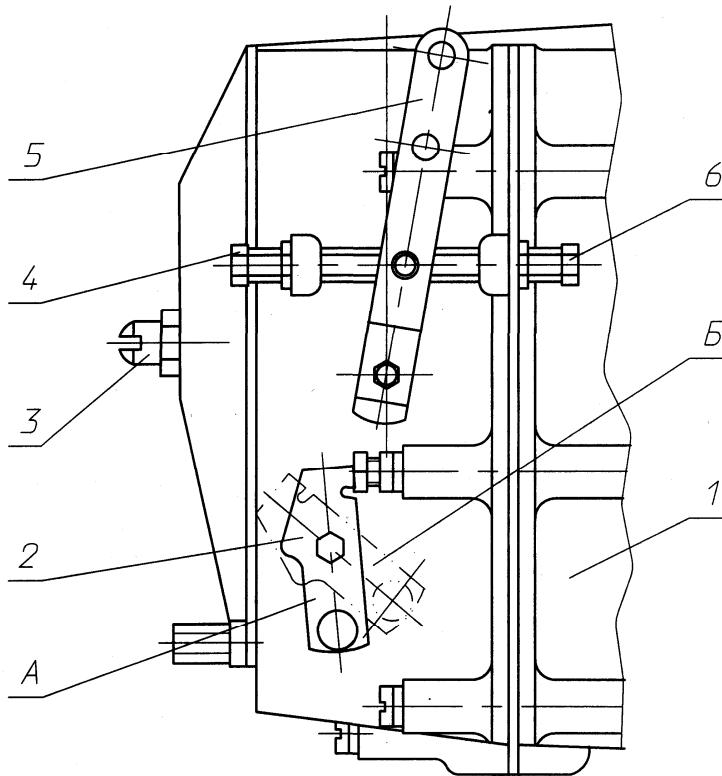
1 - регулятор; 2 - рычаг останова; 3 - корпус буферной пружины; 4 - болт ограничения минимальной частоты вращения; 5 - рычаг управления регулятором; 6 - болт ограничения максимальной частоты вращения.
