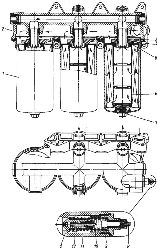
1 — колпак фильтра; 2 — корпус фильтра; 3 — прокладка колпака; 4 — замковая крышка; 5 — прокладка элемента; 6 — фильтрующий элемент; 7 — сливная пробка; 8 — клемма клапана; 9 — неподвижный контакт сигнализатора; 10 — пружина клапана; 11 — подвижный контакт; 12 — перепускной клапан.
